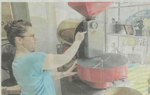
Le refroidissement des grains torréfiés produit de la fumée qui est évacuée à l'aide d'un ventilateur orienté face à l'entrée. Photo Erwann Thuot
